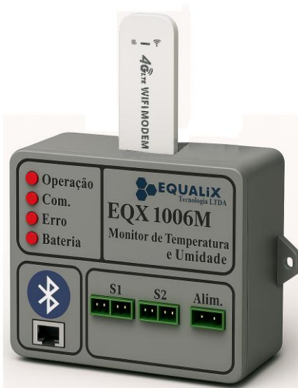
Figura 4 – Monitor EQX1006MD ligado a um modem USB.
