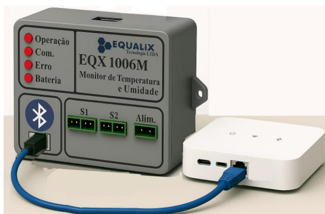
Figura 5 - Monitor EQX1006MD ligado a um modem Ethernet.
